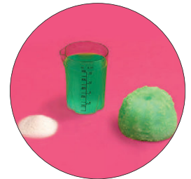
Superabsorber + Flüssigkeit = Gel
